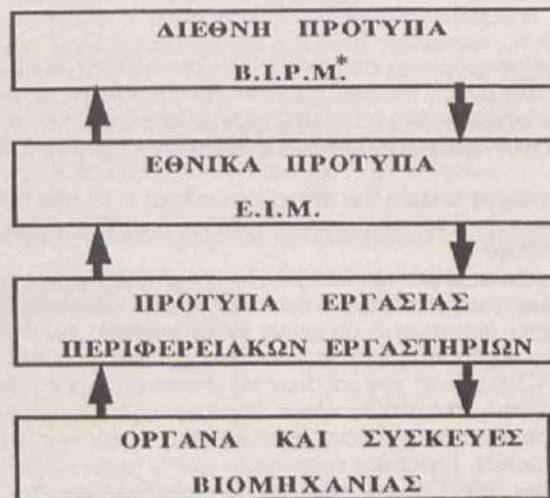
Εικόνα 1: Διάγραμμα Ιχνηλασιμότητας των Μετρήσεων που θα πραγματοποιούνται στα Εργαστήρια Διακρίβωσης στην Ελλάδα, με τη λειτουργία του Ε.Ι.Μ..
